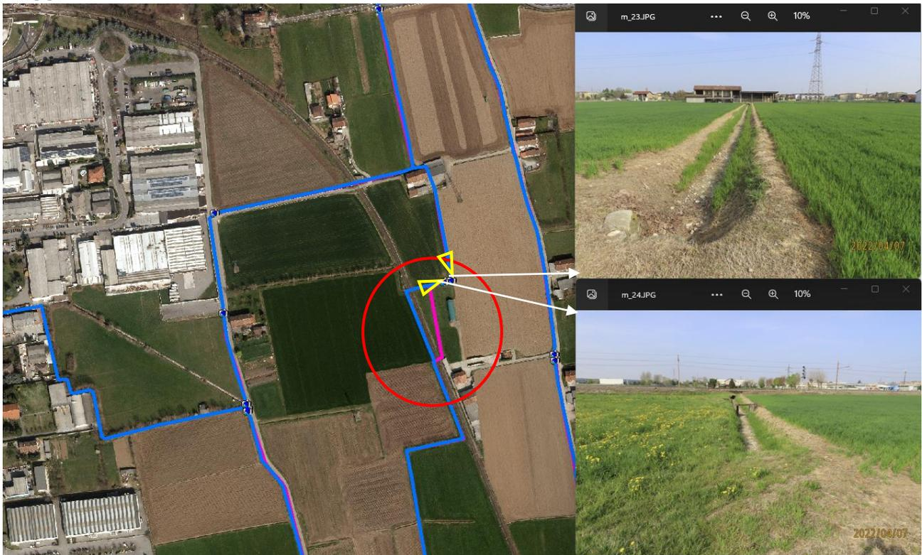
In viola il tracciato fornito dal CBMPB, in blu il tracciato verificato in loco. Il tracciato devia verso ovest e passa sotto la ferrovia.
