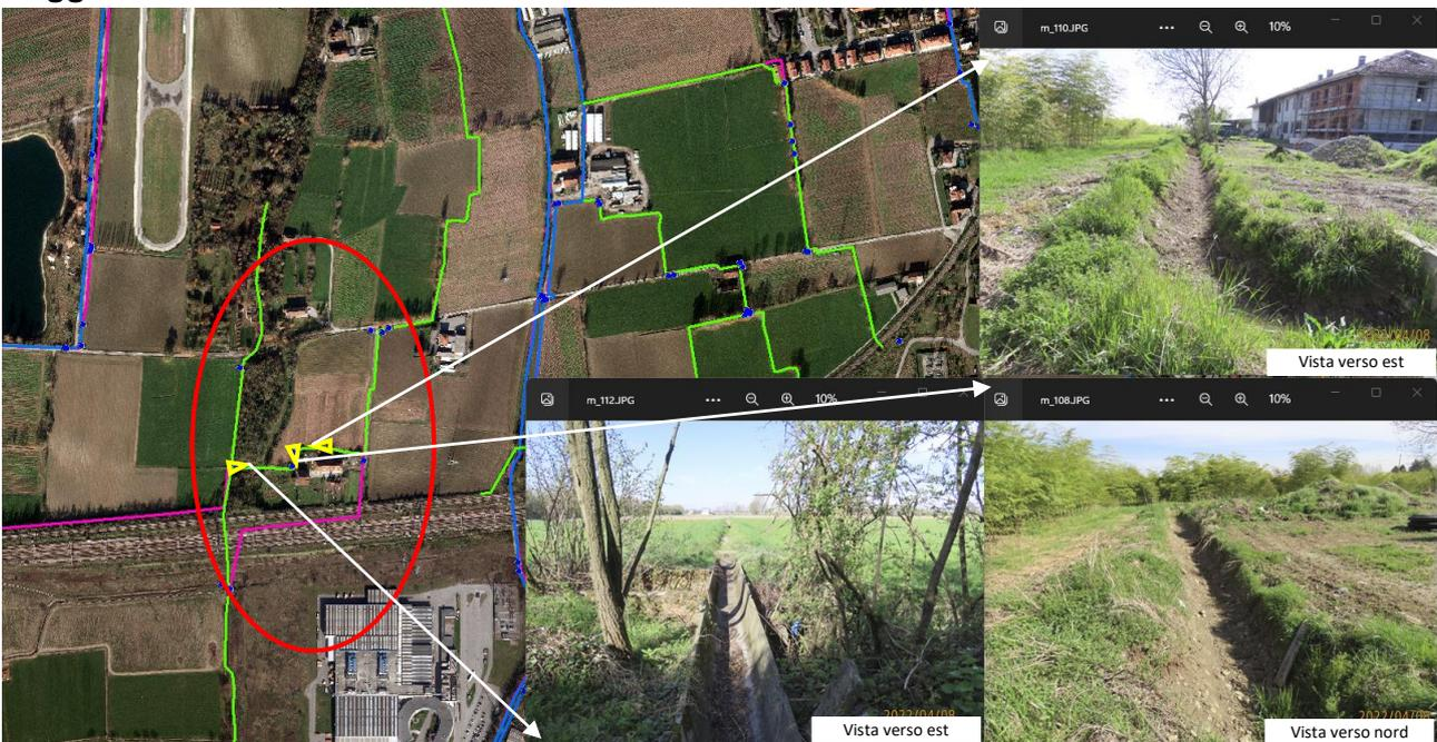
Con i lavori della ferrovia il ramo dell'Ariale Scarotti, con uso irriguo, che passa oltre la ferrovia è stato accorpato al ramo proveniente da C.na Roccolo.
